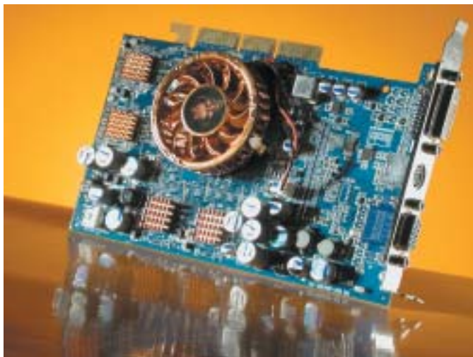
Starším a méně výkonným grafickým kartám obvykle stačí pasivní chladič (obrázek vlevo), výkonnější karta se neobejde bez chladiče aktivního (obrázek vpravo).
